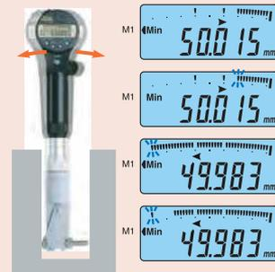
L'alesametro ABSOLUTE DIGIMATIC rileva il valore minimo (diametro vero), lo visualizza e lo blocca a display automaticamente.
