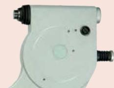
Vite di regolazione comparatore ± 5 µm
